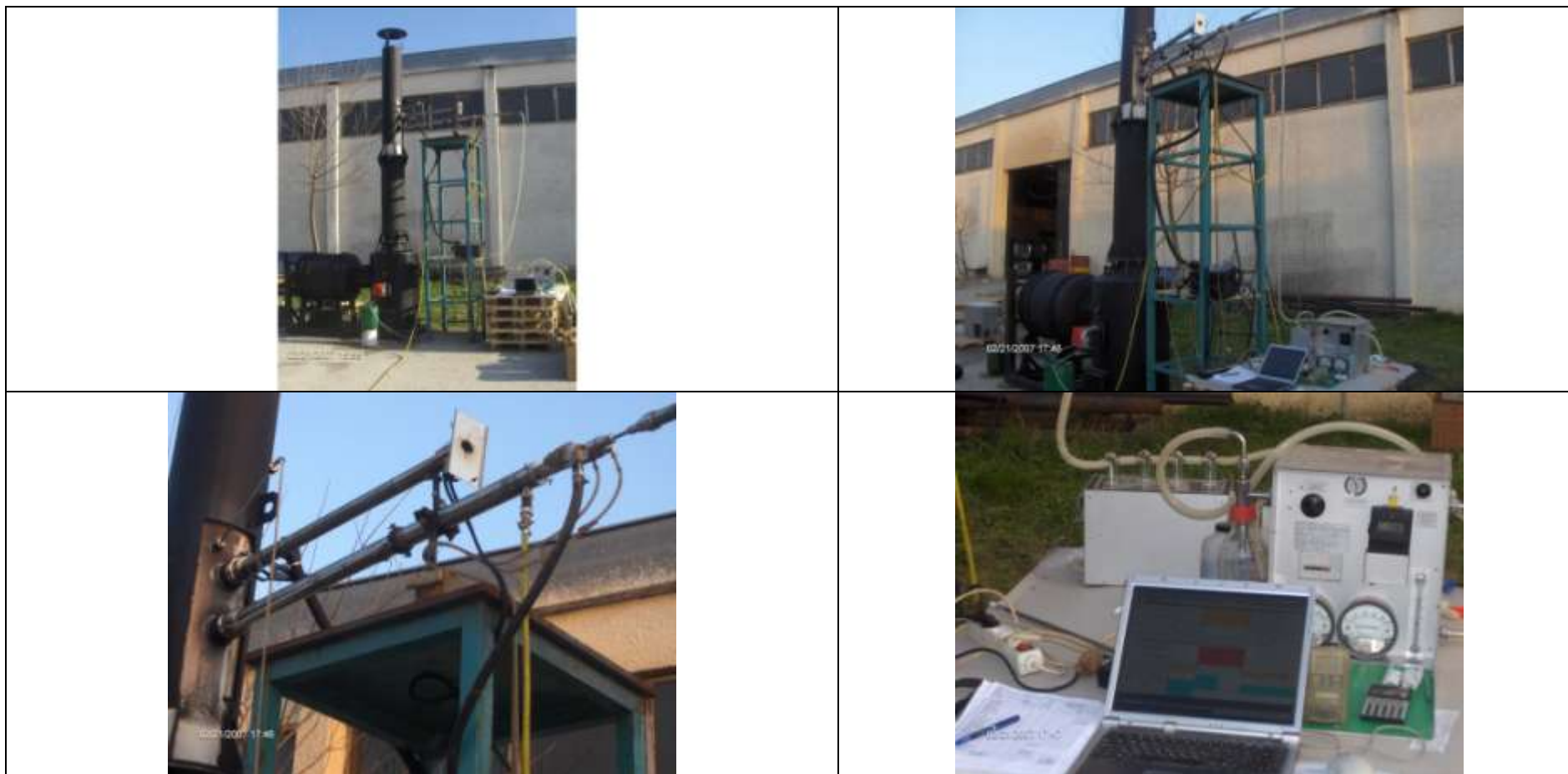
Φωτογραφία 6: Απεικόνιση της μετρητικής διάταξης για τον προσδιορισμό της συγκέντρωσης εκπομπής αιωρούμενων στερεών σωματιδίων, αερίων εκπομπών \text{SO}_2 , \text{NO}_x , \text{CO} και αλογονιδίων \text{HCl} & \text{HF} στην ατμόσφαιρα από τα καυσαέρια που δημιουργούνται κατά τη λειτουργία του κλιβάνου αποτέφρωσης ζωικών υπολειμμάτων με πρωτεύοντα θάλαμο καύσης και με θάλαμο μετάκαυσης. Οι δειγματολήπτες στο επίπεδο της θέσης μέτρησης καθώς και μέρος της μετρητικής διάταξης.
