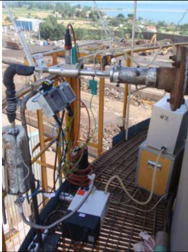
Φωτογραφία 5: Απεικόνιση της μετρητικής διάταξης για τον προσδιορισμό της κατανομής αιωρούμενων σωματιδίων κατά μέγεθος και μέρος του μετρητικού εξοπλισμού τοποθετημένος στην πλατφόρμα της καμινάδας, στο επίπεδο της θέσης μέτρησης.
