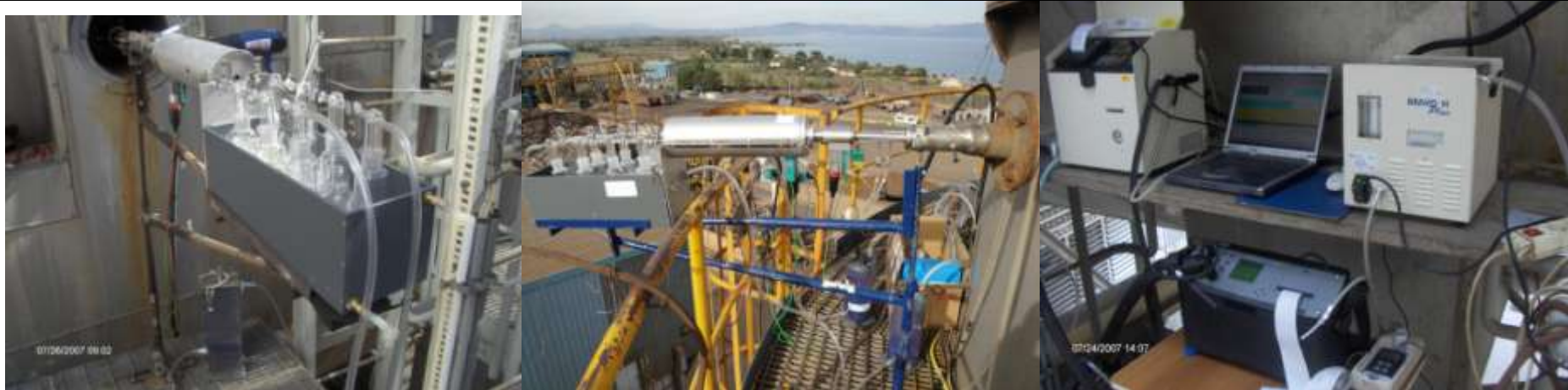
Φωτογραφία 3: Απεικόνιση της μετρητικής διάταξης για τη μέτρηση της συγκέντρωσης εκπομπής βαρέων μετάλλων και ολικού υδραργύρου , με το θερμαινόμενο δειγματολήπτη συνδεδεμένο με τη θερμαινόμενη φιλτροθήκη και τη θήκη με τις πλυντρίδες δέσμευσης βαρέων μετάλλων και ολικού υδραργύρου και μέρος του εξοπλισμού που συνοδεύει τη μετρητική διάταξη στο επίπεδο της θέσης μέτρησης.
