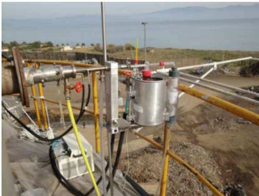
Φωτογραφία 4: Απεικόνιση της μετρητικής διάταξης για τη μέτρηση της συγκέντρωσης εκπομπής διοξινών-φουρανίων & PCBs τύπου διοξίνης , με τον ψυχόμενο σωλήνα δειγματοληψίας, το ψυγείο με τη φιάλη συμπυκνωμάτων, τη φιλτροθήκη και μέρος του εξοπλισμού που συνοδεύει τη μετρητική διάταξη, τοποθετημένου στο επίπεδο της θέσης μέτρησης.
